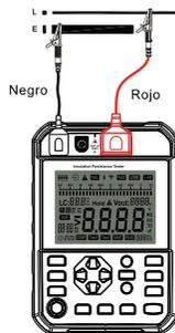
Fig. 9.3.2.1 Conexión por alambre de medición de voltaje
