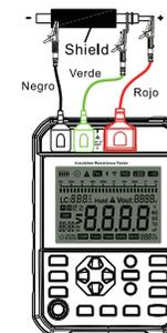
Fig. 10.1.2 Conexión de tres alambres
