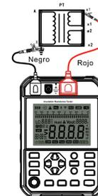
Fig. 10.2.2 Conexión de prueba
