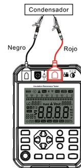
Fig. 9.3.3.1 Conexión de alambre de medición de capacitancia
