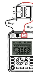
Fig. 10.2.3 Conexión de prueba
