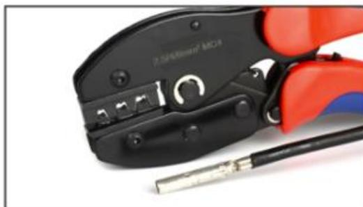
Paso 6. Terminado y conseguido un cable conectado con el conector MC4
