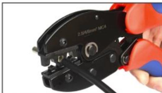
Paso 4. Coloque el cable pelado en el conector
