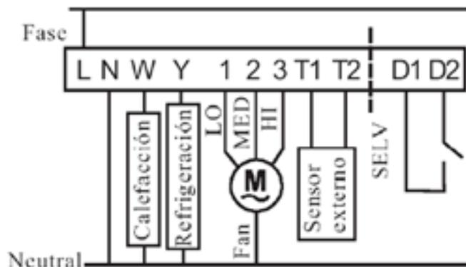
El termostato dispone de dos salidas D1 y D2 para la conexión de un contacto magnético de ventana, que en caso de dejar la ventana abierta, desactiva el termostato para evitar pérdidas de calor y energía.
