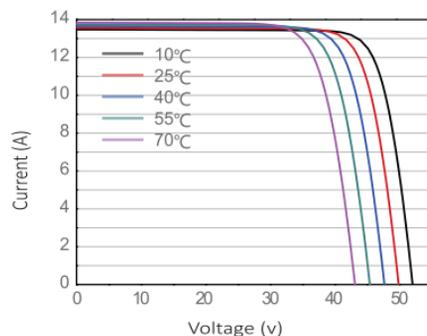
Curva corriente-tensión para diferentes temperaturas de célula.
