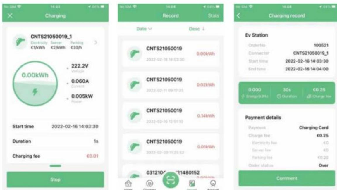
Visualización de los principales parámetros de carga del vehículo eléctrico. Según las necesidades, es posible programar los tiempos de carga, ajustar la corriente de carga, etc.
