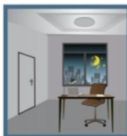
Una vez el sensor deja de detectar, si el nivel de luz es inferior al fijado en la sonda la lámpara se dimmeriza durante el periodo de tiempo fijado.
