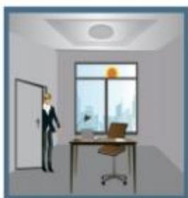
Si la luz ambiental es superior al nivel de lux fijados en el detector, la iluminación no se enciende aún si detecta movimiento.
