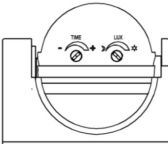
Este equipo dispone de dos potenciómetros para ajuste de tiempo, así como ajuste crepuscular.
