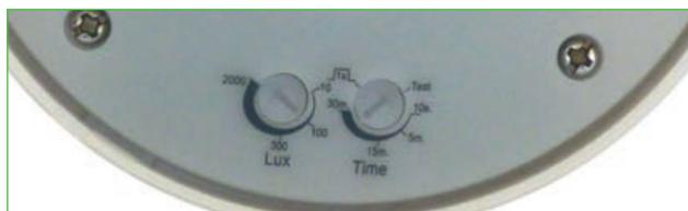
Les sélecteurs ajustables de temps et de luminosité permettent d'aligner les valeurs souhaitées d'éclairage et de temps de fonctionnement en assurant un faible coût et des économies d'énergie.
